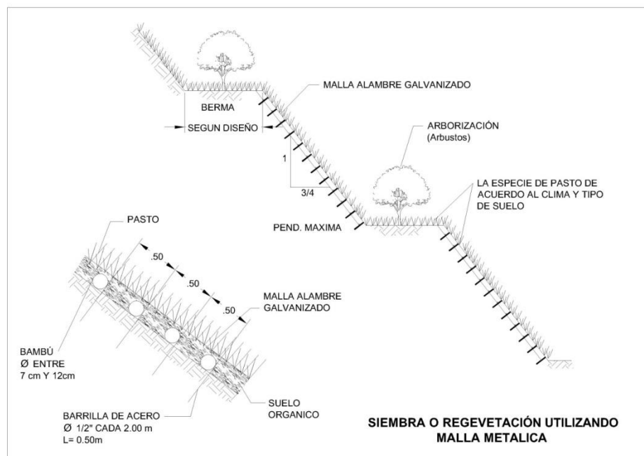
Figura 17. Siembra o revegetación utilizando Malla Metálica.
